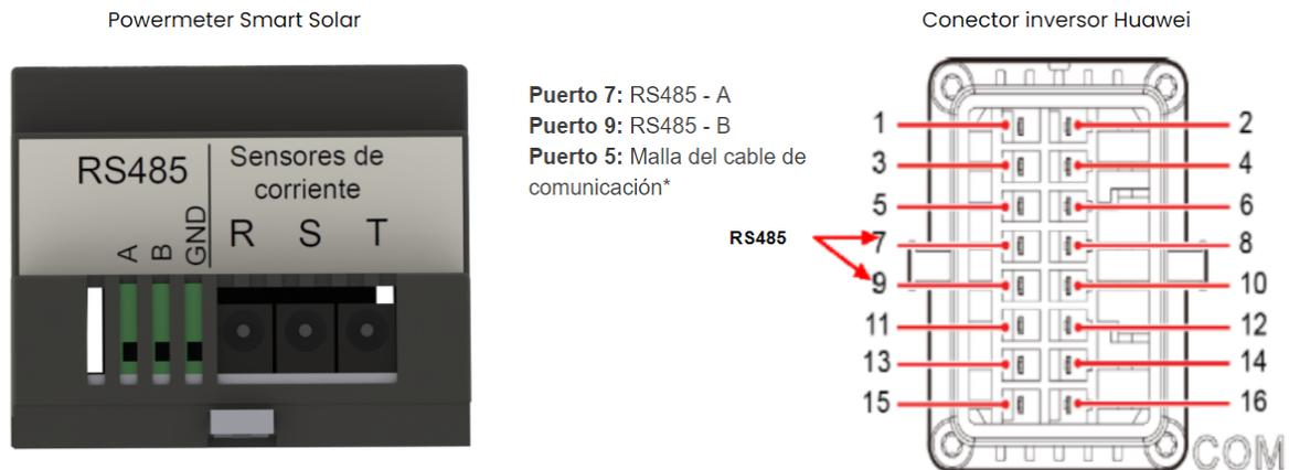
*Diagrama de conectores Powermeter Smart Solar y puerto de comunicación inversores Huawei trifásicos M0/M1.*
